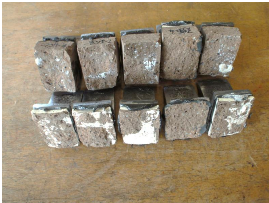
Bild: Verklebung ideal: Bruchversagen im Altrohr-Material.
