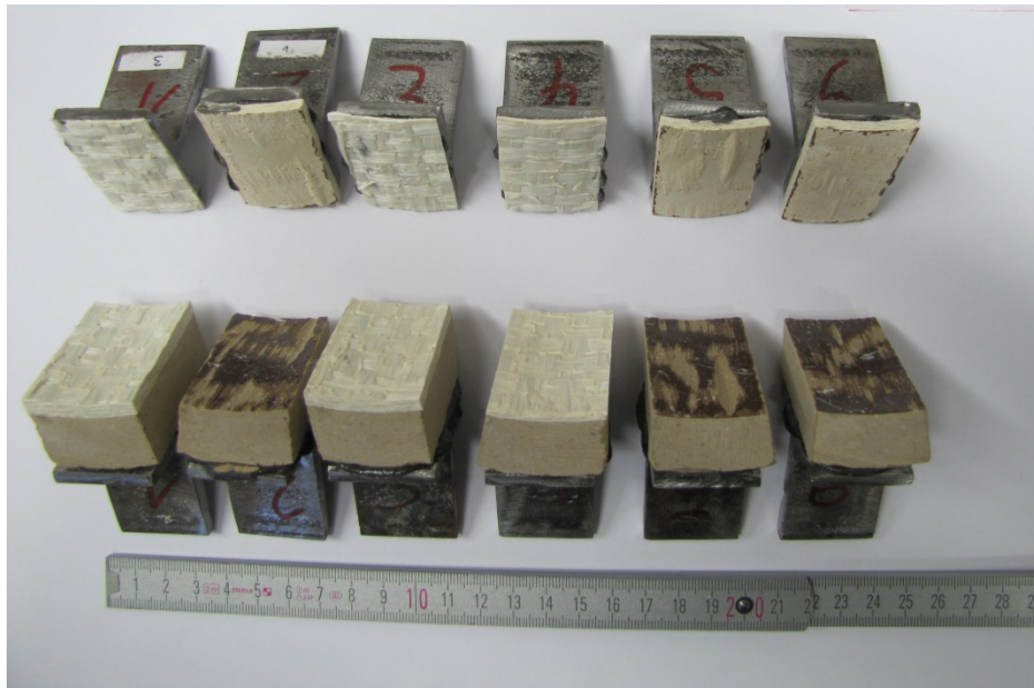
Bild: Verklebung auf nicht hinreichend vorbereiteten Untergründen - nass, fettig (Sielhaut), staubig (Frässtaub)
