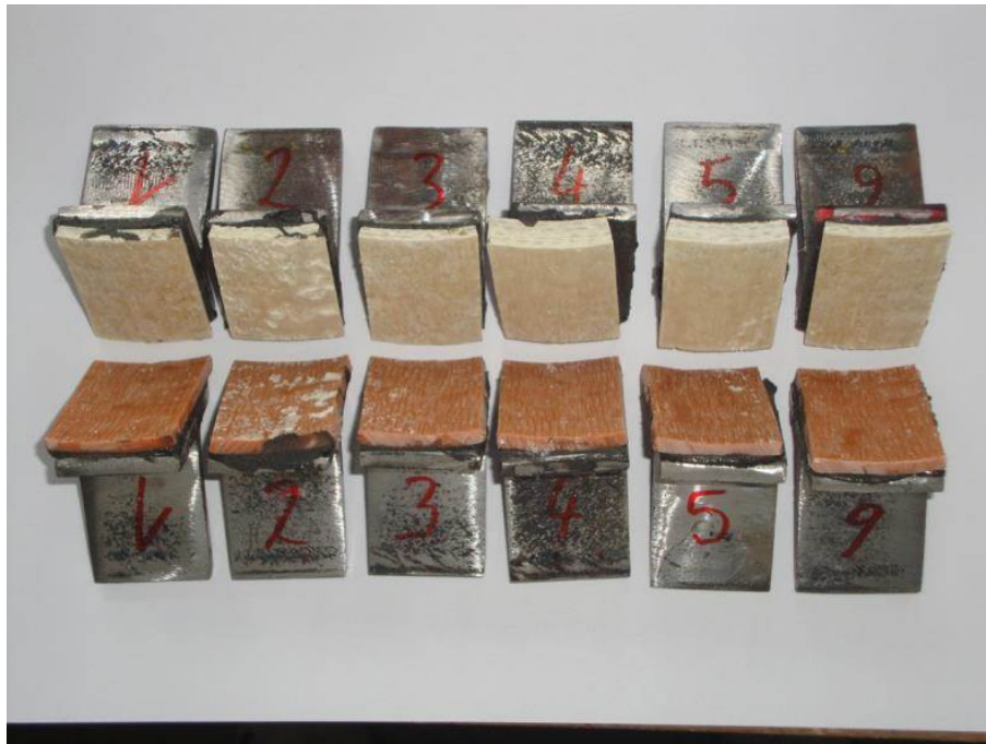
Bild: Haftzugprüfung in einem alten PVC-Rohr, Bruch an der Grenzfläche der Verklebung, Ergebnis: Keine optimale Verklebung erreicht
