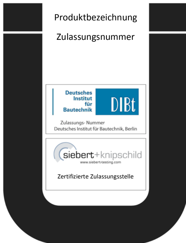
Bild: Übereinstimmungszeichen gemäß allgemeiner bauaufsichtlicher Zulassung des DIBt
