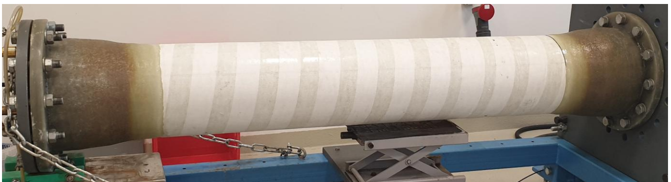
Beispiel IBB 16 Druckliner (von IBG Hydrotech) in Prüfung
